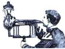
Мал. 2. Динамометр Й. Шедіви «Інструкція для виробництва», 1896 [20; 61].
